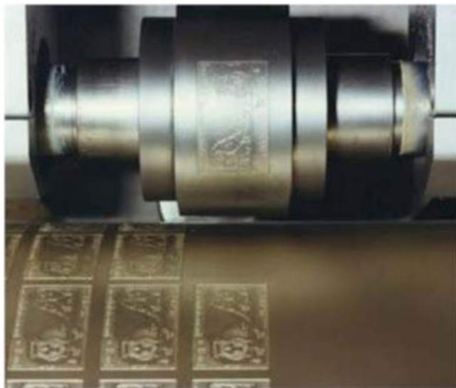
overdracht met een moleteermachine van de gravure op de ferrule
