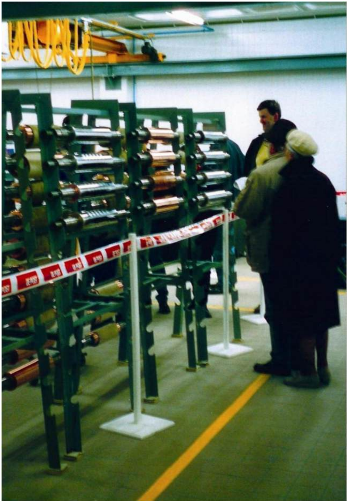
De opslaguimte van de drukcilinders
