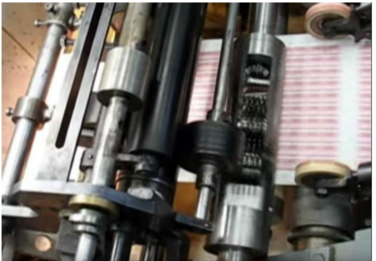
De cilinder die de drukdatum en het velnummer drukt met de inktcilinder
