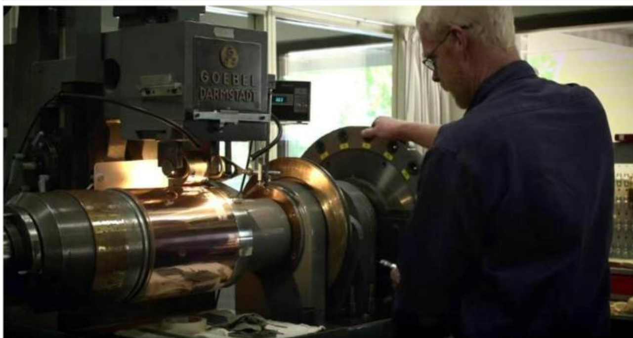
De Goebel moleteermachine voor het aanmaken van de drukcilinder
