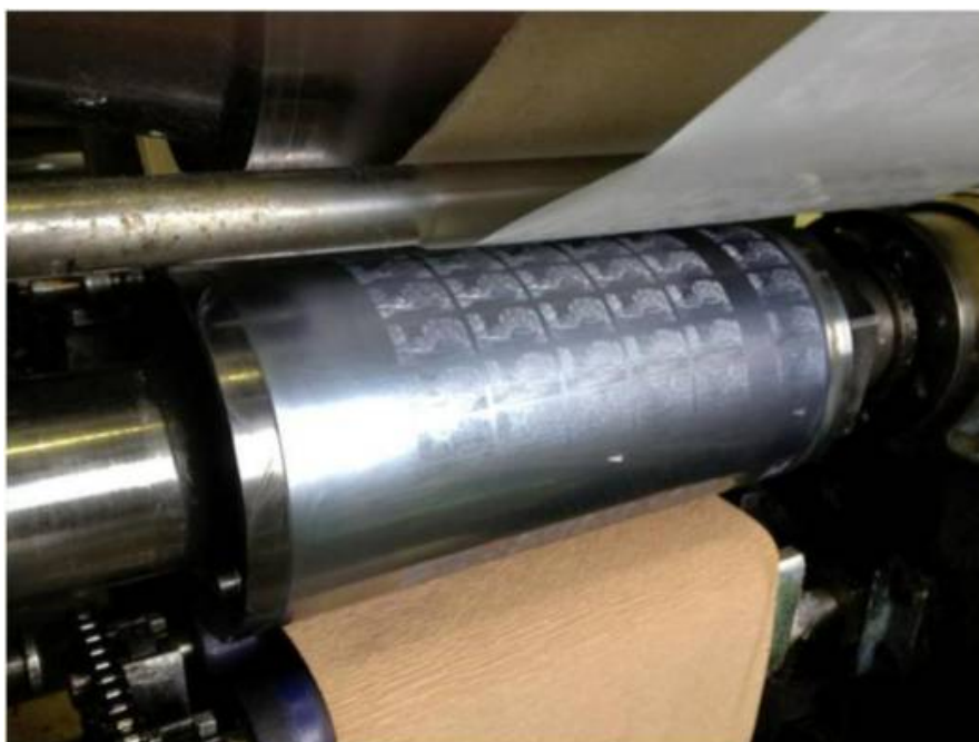
Exemple d'impression et le rouleau buvard sur la presse Wifag
