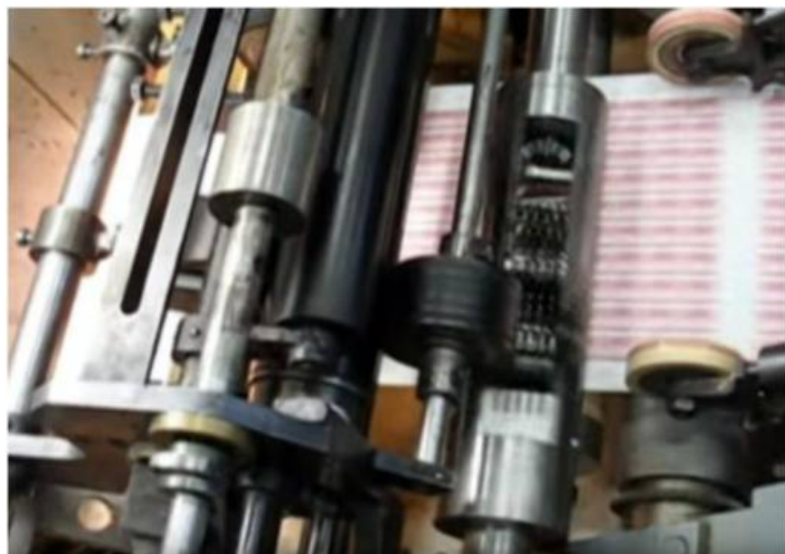
Le cylindre qui imprime la date d'impression et le numéro de feuille et le cylindre encreur
