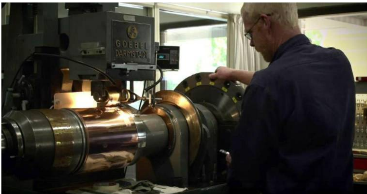
La presse de moletage Goebel sur laquelle la virole est produite
