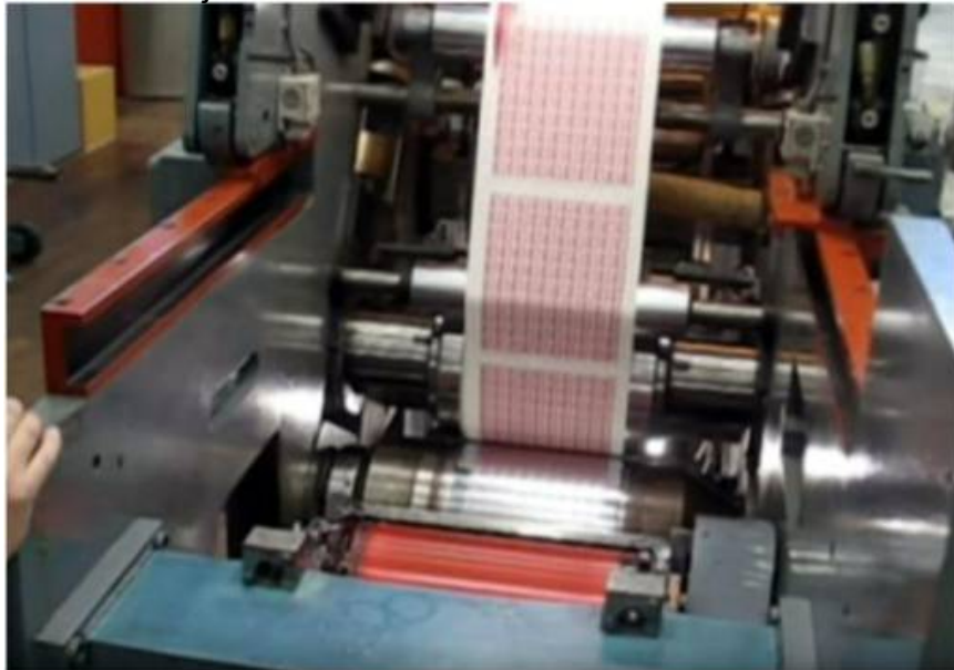
L'ajout de l'encre et les rouleaux encres
