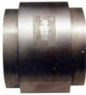
Molette avec motif à l'endroit et en relief
