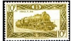
**TR316** : En 1920, une locomotive de type 2-8-0 construite aux États-Unis, appelée 'Consolidation', a été mise en service sur le réseau ferroviaire belge. Cette locomotive a remplacé les exemplaires perdus pendant la Première Guerre mondiale. Il s'agissait de locomotives de trains de marchandises, et 150 unités ont été mises en service sous le type T.38. Elles pesaient 85 tonnes et pouvaient atteindre une vitesse de 75 km/h.
